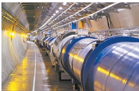
Рис. 135. Участок кольца коллайдера в тоннеле
